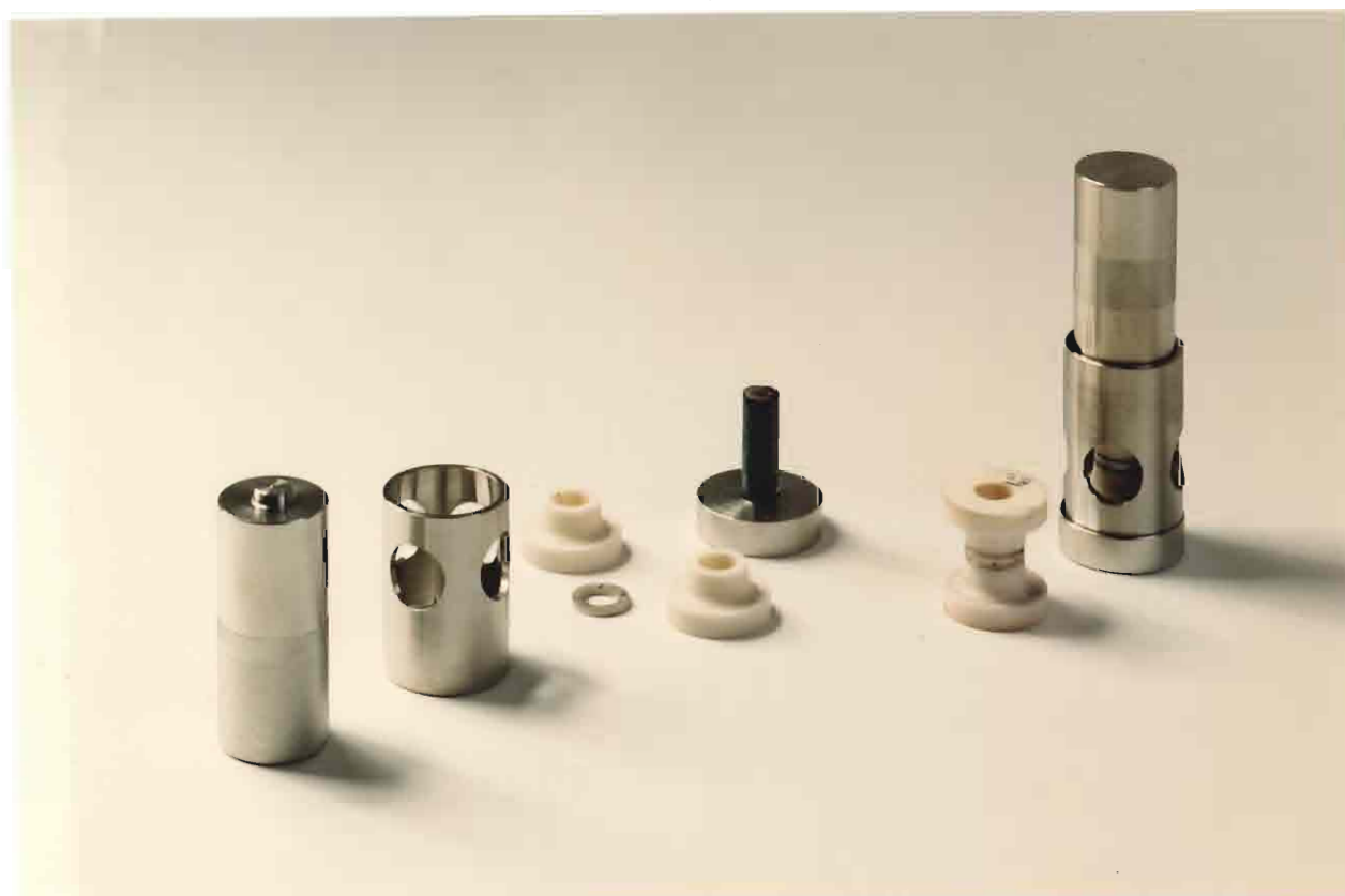
Figuur 10: De fixatiemal, v.l.n.r. het aandrukgewicht, de buitenhuls, de proefstukonderdelen, de keramische centreerpen met bodemplaat, een gesoldeerd proefstuk en de gemonteerde mal met proefstuk. De fixatiemal is vervaardigd van roestvaststaal AISI 316.
